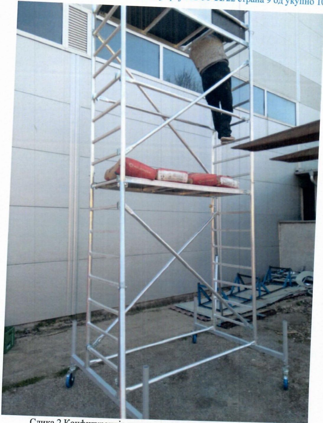
Слика 2 Конфигурација за тест носивости покретне платформе-скеле
