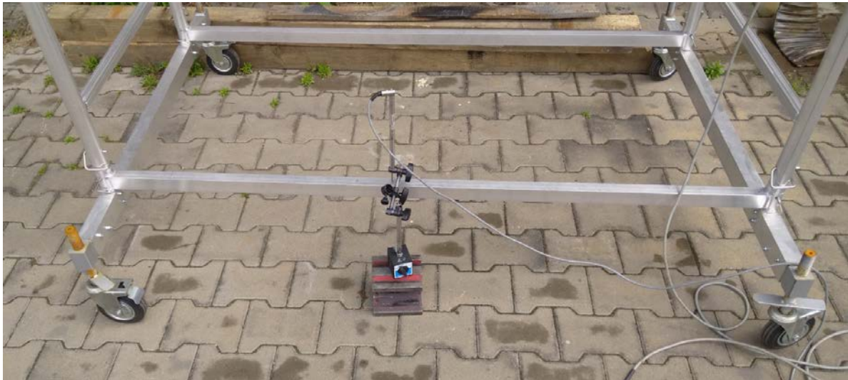
Слика 11. Мерна ћелија помераја која региструје покретање скеле услед бочне силе
