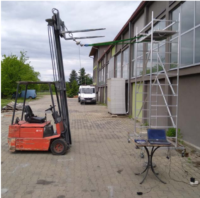
Слика 9 Контрола бочне стабилности под дејством оптерећења 0,30kN
