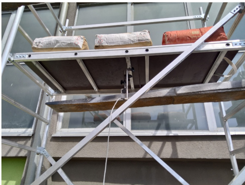
Слика 6 Мерна ћелија угиба на средини платформе покретне скеле у фази са 3 џака цемента
