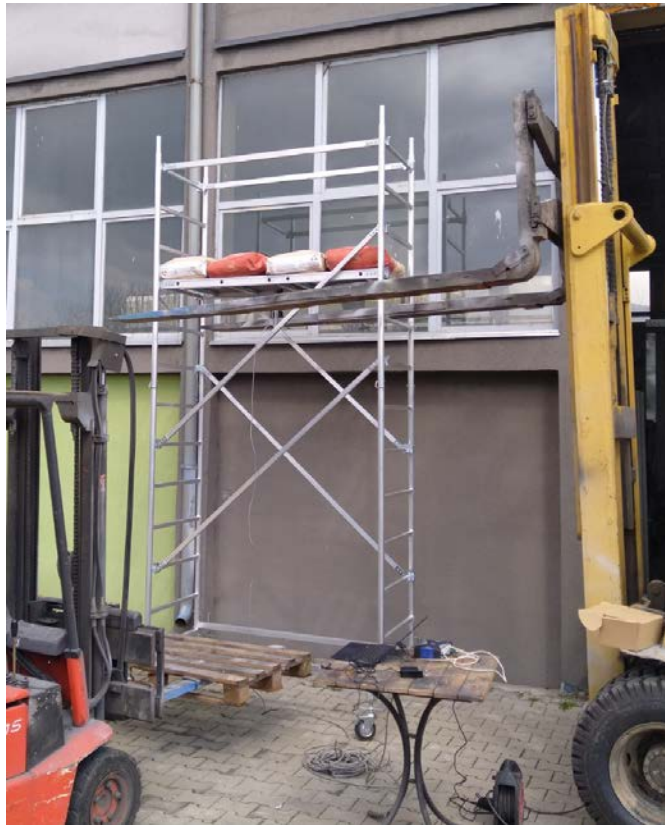
Слика 2 Конфигурација за тест носивости покретне платформе-скеле
